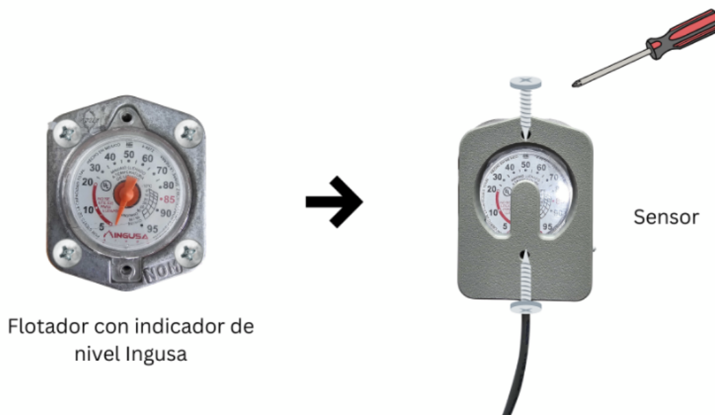
Figura 4 Instalación de la carátula indicadora de nivel Ingusa y del sensor del monitor Levix
